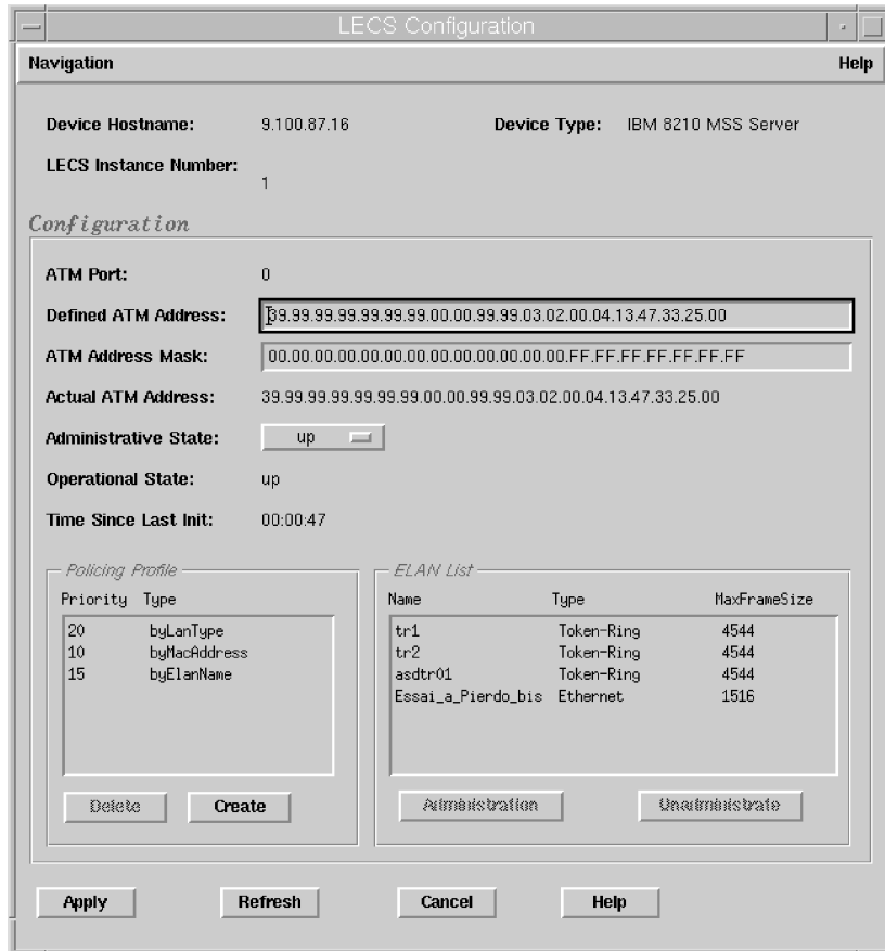
図 62. 「LECS Configuration (LECS 構成)」 パネル
